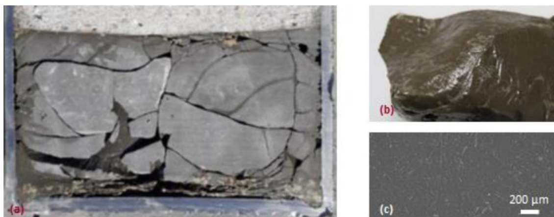
図9 (a) 焼却灰で製造した廃棄物負荷率 50% のキャニスタ断面 (b) 焼却灰の拡大写真 (c) 結晶化した固化体マトリックスの走査型電子顕微鏡画像
